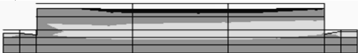
Рис. 5. Горизонтальные нормальные напряжения \sigma_x (МПа) в модели «плотина-основание» под действием собственного веса (а), веса и гидростатики (б)
