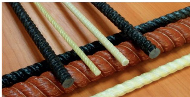
Рис. 1. Композитная арматура
