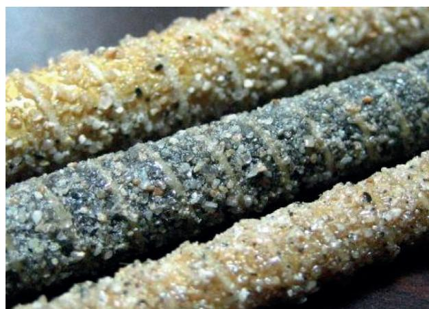
Рис. 3. Композитная арматура, покрытая песочным напылением
