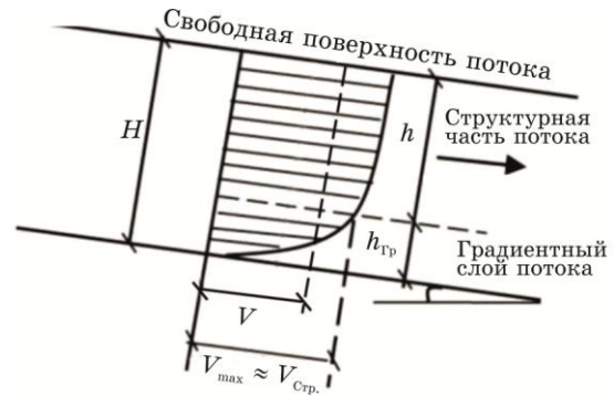
Схема распределения скоростей по вертикали в селевом потоке (пояснения в тексте)
