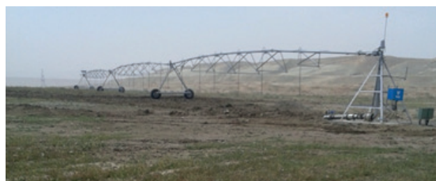
Рис. 3. Машина кругового типа Valley на территории Хызинского района
